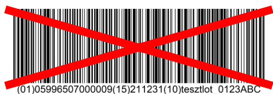
6. ábra: Ha a túl széles vonalkódot összenyomjuk, olvashatatlaná válhat
