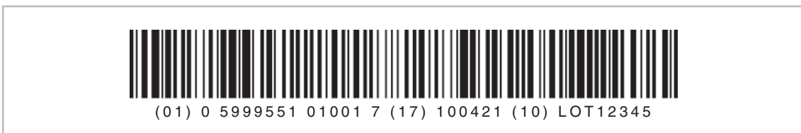
15. ábra: GS1-128 jelkép GTIN szám-mal és kiegészítő információkkal (fogyaszthatósági határidő és gyártási tételszám)
