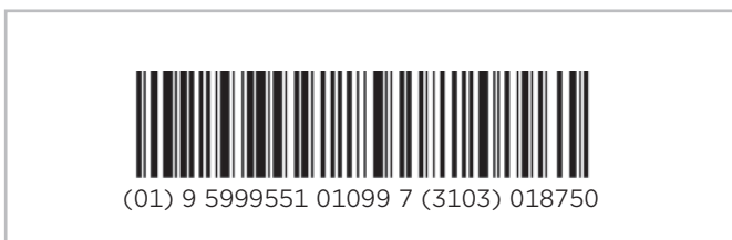
34. ábra: A GTIN számot és a Nettó tömeget ábrázoló GS1-128 vonalkód jelkép
